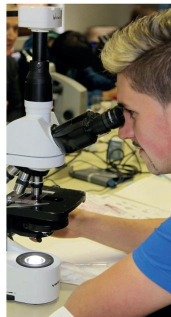
Der Belebtschlamm wird täglich labortechnisch untersucht.
